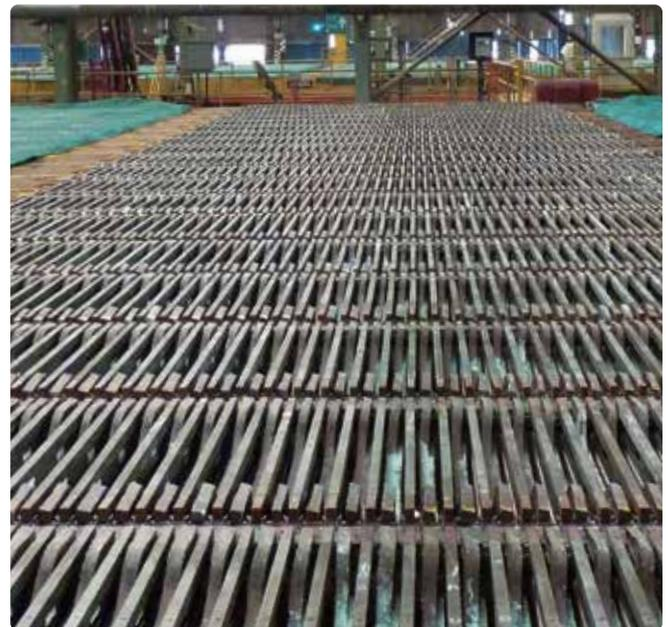
Anoden im Elektrolysebad.
