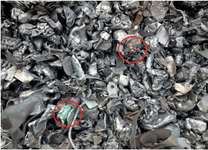
FE-Schrott aus der E-Schrott-Aufbereitung mit NE-Anteilen
