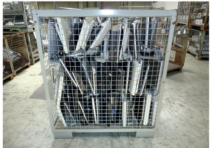
Bild 3: Sammelbox für LCD- Bildschirmgeräte der Electrocyling GmbH (Quelle: Electrocyling GmbH 2013)
