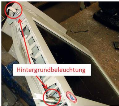
Bild 1: Lage der CCFL-Röhren bei LCD-Monitoren
