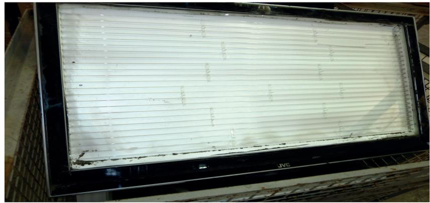
Bild 2: Lage der CCFL-Röhren bei LCD-TV-Geräten,
