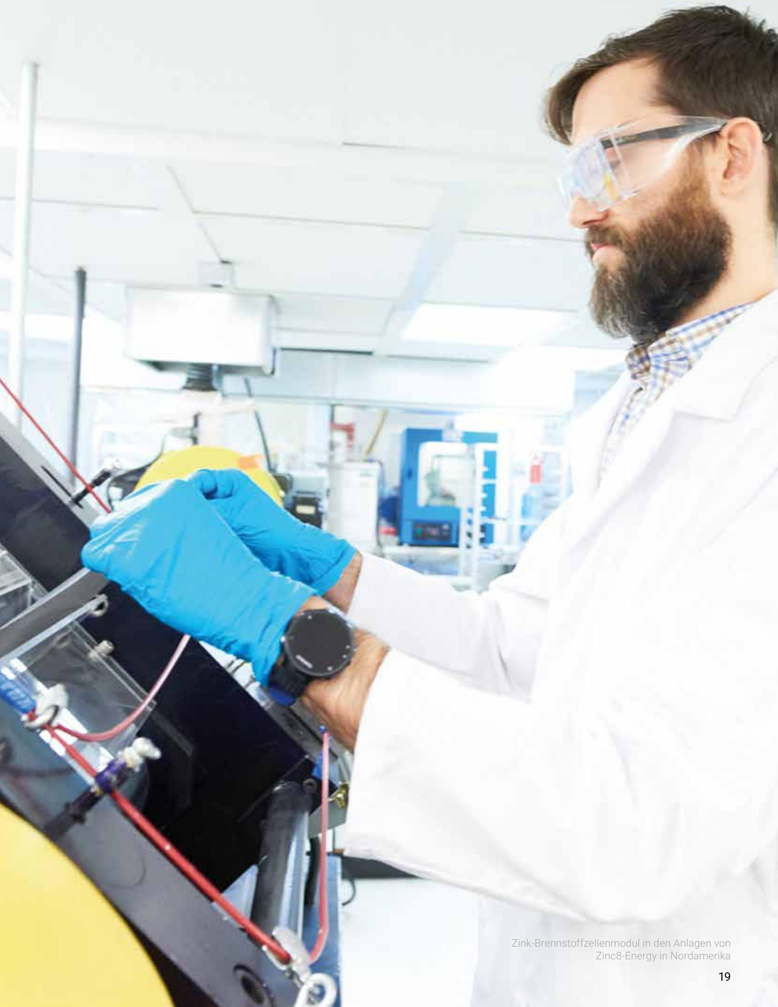
Zink-Brennstoffzellenmodul in den Anlagen von Zinc8-Energy in Nordamerika
