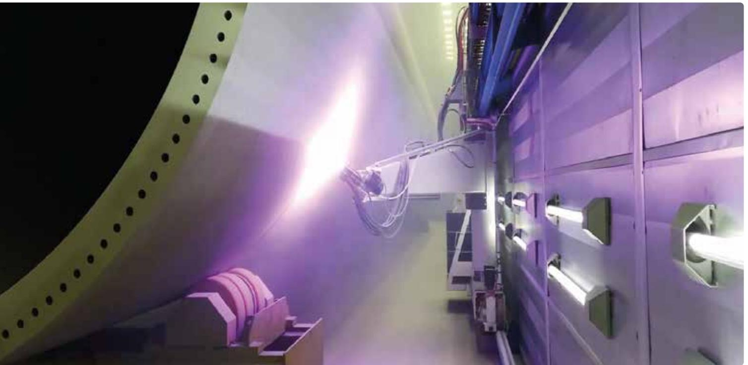
Automatisches Spritzverzinken eines Windkraft-Turmsegmentes
